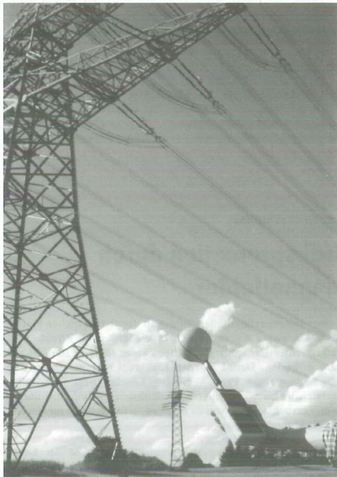
Abb. 2: Messung der magnetischen Felder in der Nähe einer Hochspannungsleitung.
